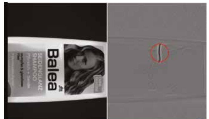
Rilevamento di un difetto sulla superficie di una bottiglia di shampoo
