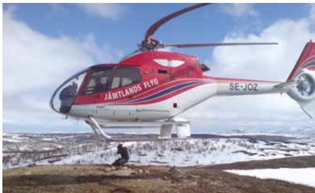
Effetto di acquisizione con sensore rolling shutter: distorsione delle pale dell'elicottero
