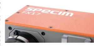
Nel caso del vino abbiamo fatto uso delle telecamere iperspettrali SPECIM FX10, con banda spettrale 400-1000nm, e FX17 che lavora nella banda spettrale 900-1700nm. Durante le misure è stato possibile determinare, con opportune calibrazioni, la concentrazione di resveratrolo all'interno di campioni di vino rosso.
