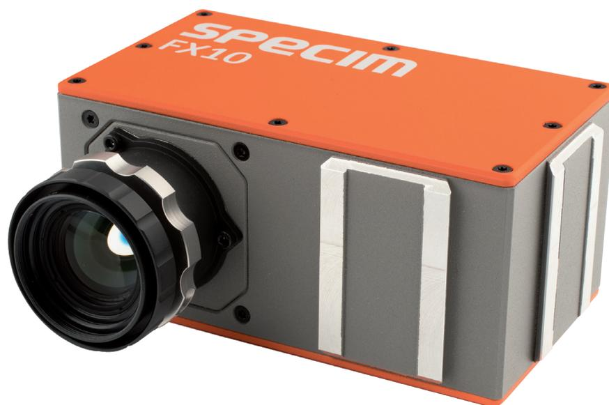
La FX10e di Specim è in grado di fornire dati iperspettrali formattati in un ipercubo con 224 bande, selezionabili da 400 a 1.000 nm, a una velocità di 327 Hz.
